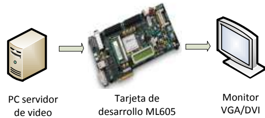
Fig. 7. Montaje de verificación del sistema.
