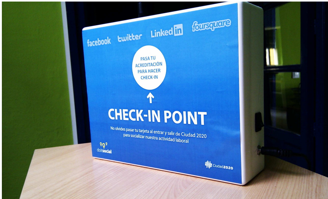
Fig. 4. Configuración de un dispositivo Intelify como check-in point para comunicar la presencia de personas en las principales redes sociales.
