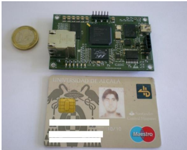
Fig. 2 Mini-Modulo HW de altas prestaciones y de espacio reducido
